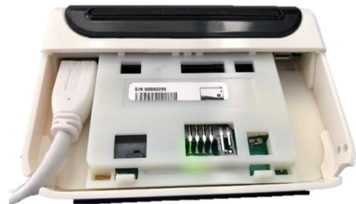
**IMPORTANT** : Couder fortement le câble USB 3.0 en point de sortie pour qu'il ne gêne pas la stabilité du lecteur en usage vertical, puis enclencher le capot sur la partie haute et le clipser sur tout son contour.
