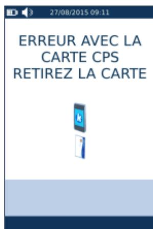
Retirer la carte CPS et retenter l'opération en vérifiant que la carte CPS est bien insérée avec la puce orientée vers l'eS-KAP-Ad® -vR, jusqu'au bout de course de la carte.
